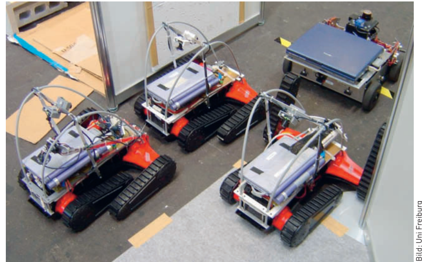
Oben: Die in der Kategorie ‚Autonomie‘ siegreichen Rettungsroboter der Uni Freiburg. Zur Koordination mehrerer Roboter verteilen die Fahrzeuge RFID-Chips im Gelände.
