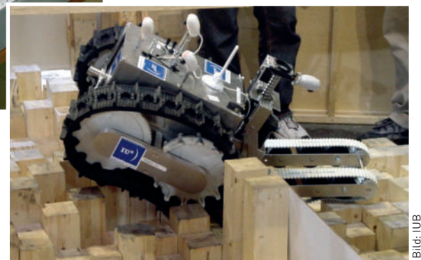
Unten: Mit Hilfe der hochklappbaren Teile des Raupenantriebs können die IUB-Roboter selbst Treppen überwinden.
