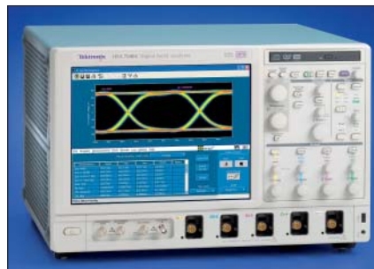
Bild 1: Das 4-kanalige 20-GHz-Oszilloskop DSA72004 hat eigentlich eine analoge Bandbreite von nur 16 GHz, die per digitaler Signalverarbeitung aber auf 20 GHz angehoben wird. Diese DSP-Betriebsart kann für jeden Kanal individuell zu oder abgeschaltet werden.
