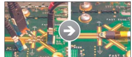
Bild 3: Die TriMode-Umschaltung macht's möglich: Drei verschiedene Messungen am selben festen Messpunkt.
