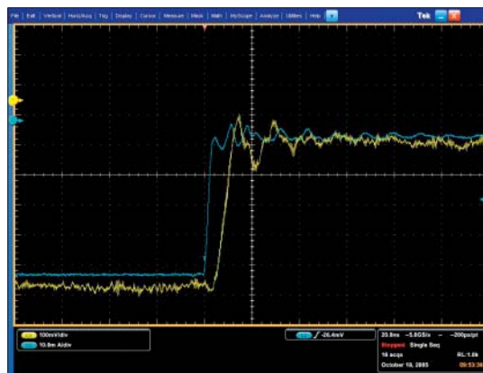
Bild 2: Laufzeitverzögerung bei einem Spannungs- und Stromsignal
