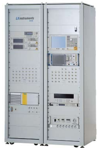
Bild 1: Testsystem von LX Instruments: Auf der linken Seite befindet sich ein Simatic Rack PC 547B zur Steuerung des Gesamtsystems
