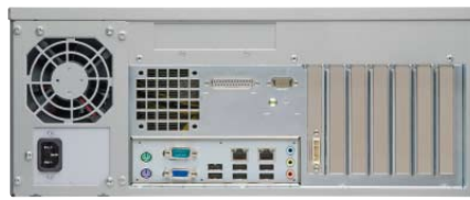
Bild 3: Der Simatic IPC547C verfügt über zahlreiche Schnittstellen (z. B. 9 x USB, 2 x Ethernet, COM, PS / 2) und kann bis zu sieben PCI-/PCIe-Erweiterungskarten aufnehmen
